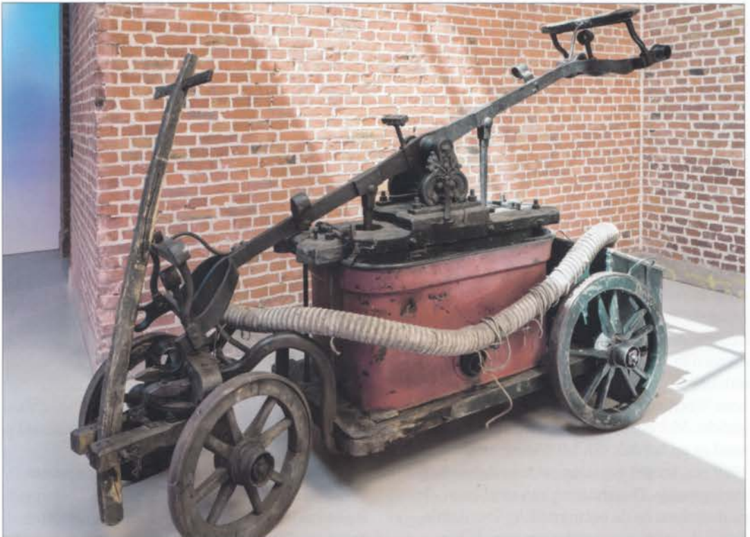
Brandspuit, voorzien van een brandslang zonder naad. Gebouwd in 1835, afkomstig uit blekerij Ten Cate in Eibergen. Collectie Oudheidkamer Twente.
